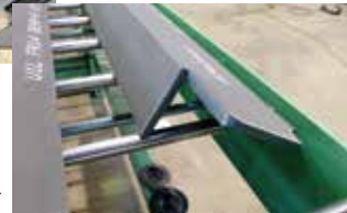
ANG-差込み切断
